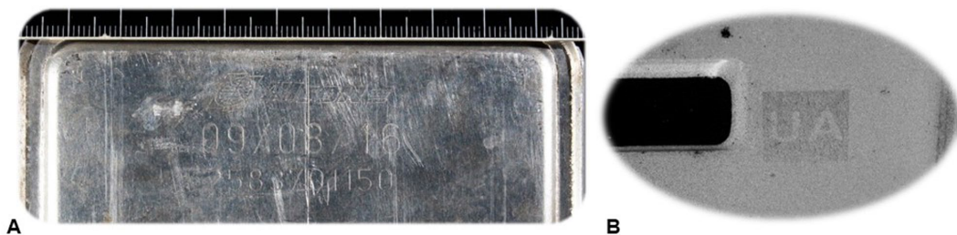
67. ábra – A: Cseh hosszúságú rendszám tábla gyártói jelzései, B: Ukrán hosszúságú rendszám tábla egyik védelmi eleme. (a szerző saját felvétele)
