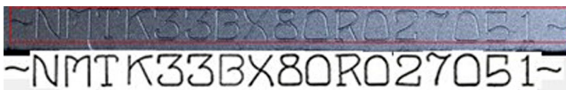
54. ábra – Részletkép a hamis alvázszaőről (felül) és a gyári eredetű karakterekőről (alul). (a szerző saját felvételei)
