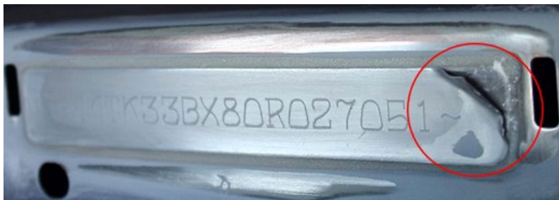
55. ábra – Részletkép a hamis alvázszaőről. (a szerző saját felvétele)
