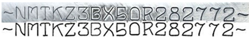
56. ábra – Részletkép a gyári eredetű alvázszámról (felül) és gyári eredetű karakterekről (alul). (a szerző saját felvételei)
