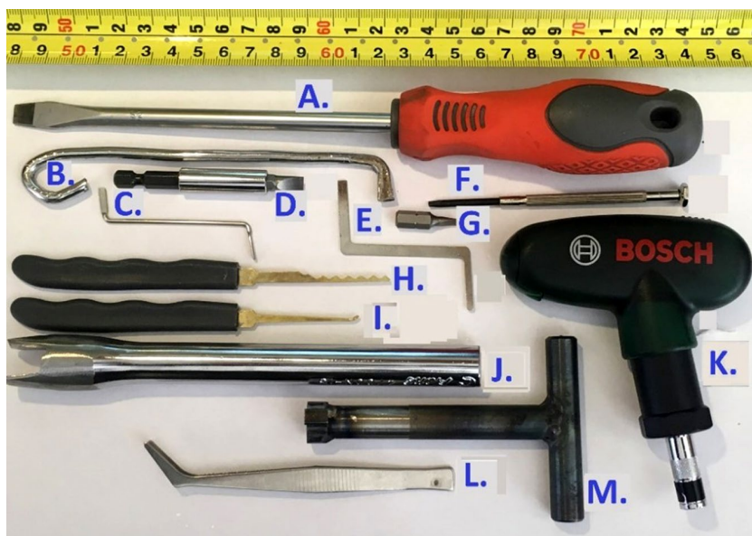
40. ábra – A-D-F-G-K: csavarhúzó, B-C-E-H-I-L-M: álkulcsként használható speciális célszerszámok és segédeszközök, J: hengerzár feszítő-törő célszerszám. (a szerző saját felvétele)
