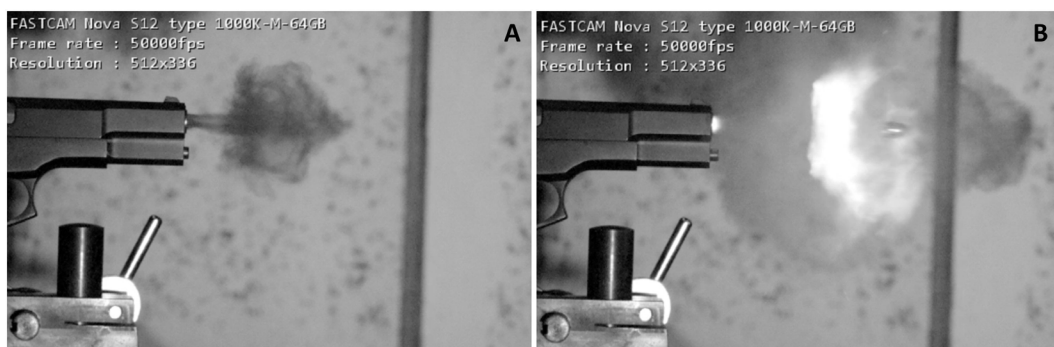
11. ábra – A: a csőtorkolaton lövés közben kiáramló füst, B: a torkolattűz, a kiáramló füst és a lövedék. (a szerző saját felvételei)
