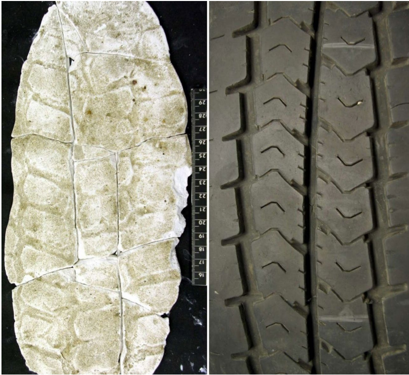
52. ábra – Kizárás – A: az egyik gépjármű nyom mintázata, B: a jobb első gumiabroncs mintázata, a két mintázat eltér egymástól, A \neq B . (a szerző saját felvételei)
