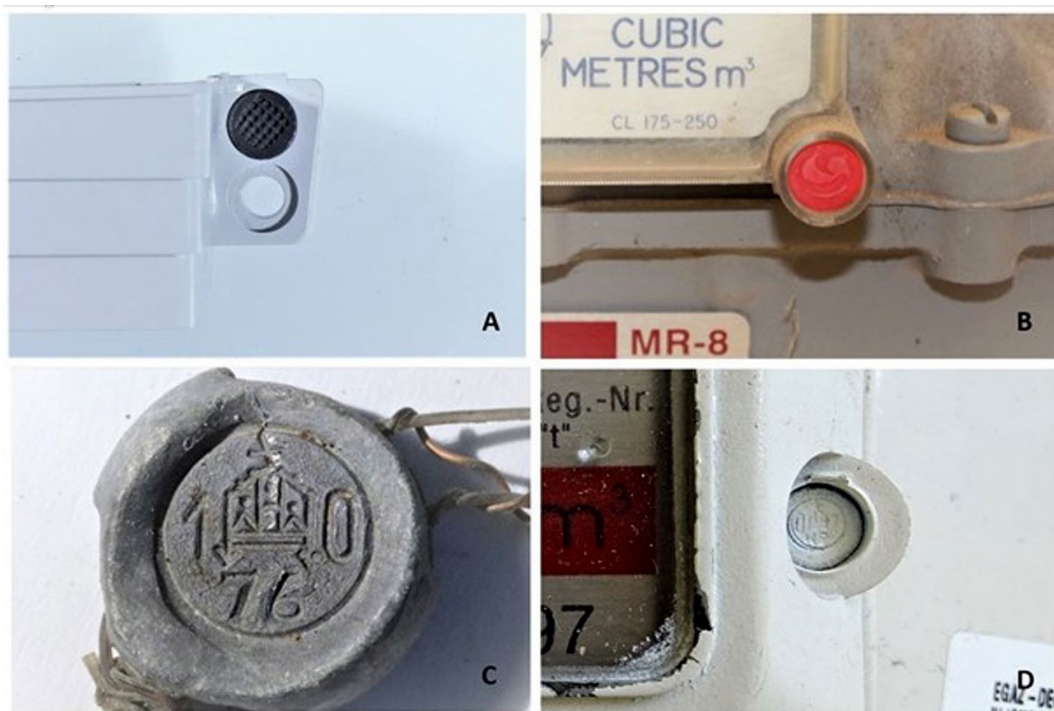
72. ábra – A: gyártóműi plomba, B: gyártóműi csavarvédő, C: hatósági hitelesítési plomba, D: hatósági hitelesítési csavarvédő. (a szerző saját felvételei)
