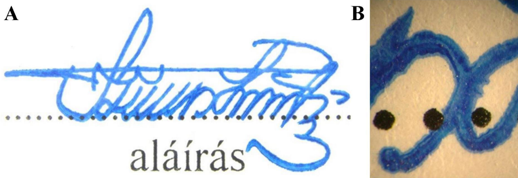
28. ábra – A: Névbélyegző Canon EOS 1100D, normál optika, árnyékmentes körmegvilágítás, B: makroszkópi részletkép a bélyegzőfesték márványos megjelenéséről, Wild M400 sztereomikroszkóp, nagyítás 20x, körmegvilágítás. (a szerzők saját felvételei)
