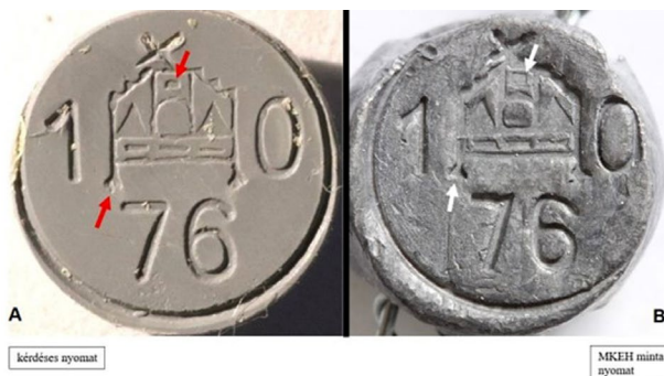
77. ábra – A: hamis bélyegnyomóval készített hitelesítési bélyegnyomat, B: MKEH minta nyomat. (a szerző saját felvételei)
