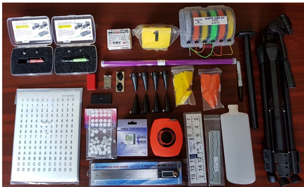
6. ábra – Lézeres lőirány meghatározó készlet, mely lézerpointereket, állványt, színes lőirány jelölő köteleket és szondákat is tartalmaz (a szerző saját felvétele)
