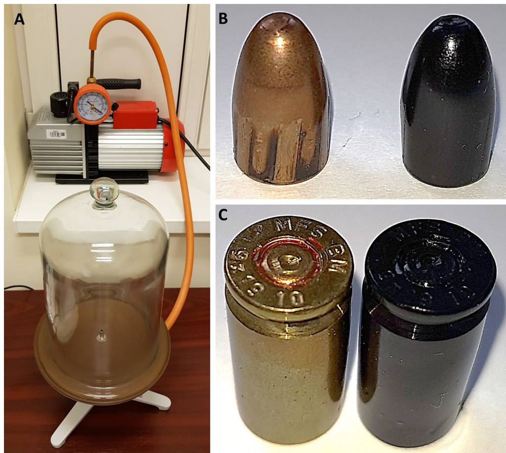
9. ábra – A: vákuumbúra a vákuumszivattyúval, B: az eredeti és a mikronyomok szintjén azonos lövedék másolat; C: az eredeti és a mikronyomok szintjén azonos töltényhüvely másolat. (a szerző saját felvételei)
