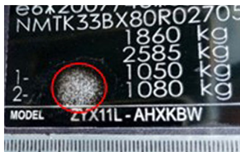
62. ábra – Metrikus kép a hamis típusábláról (matricáról). (a szerző saját felvétele)
