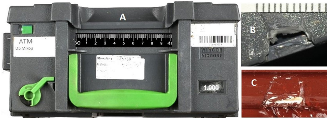
41. ábra – A: felfeszített megrongálódott bankjegy rekesz, B: bankjegy rekesz felfeszítése során keletkezett statikus és dinamikus eszköznyom-töredék, C: Befeszített bejárati ajtó tokján szilikon gumi nyomrögzítővel megmintázott feszítési eszköznyom töredék. (a szerző saját felvételei)
