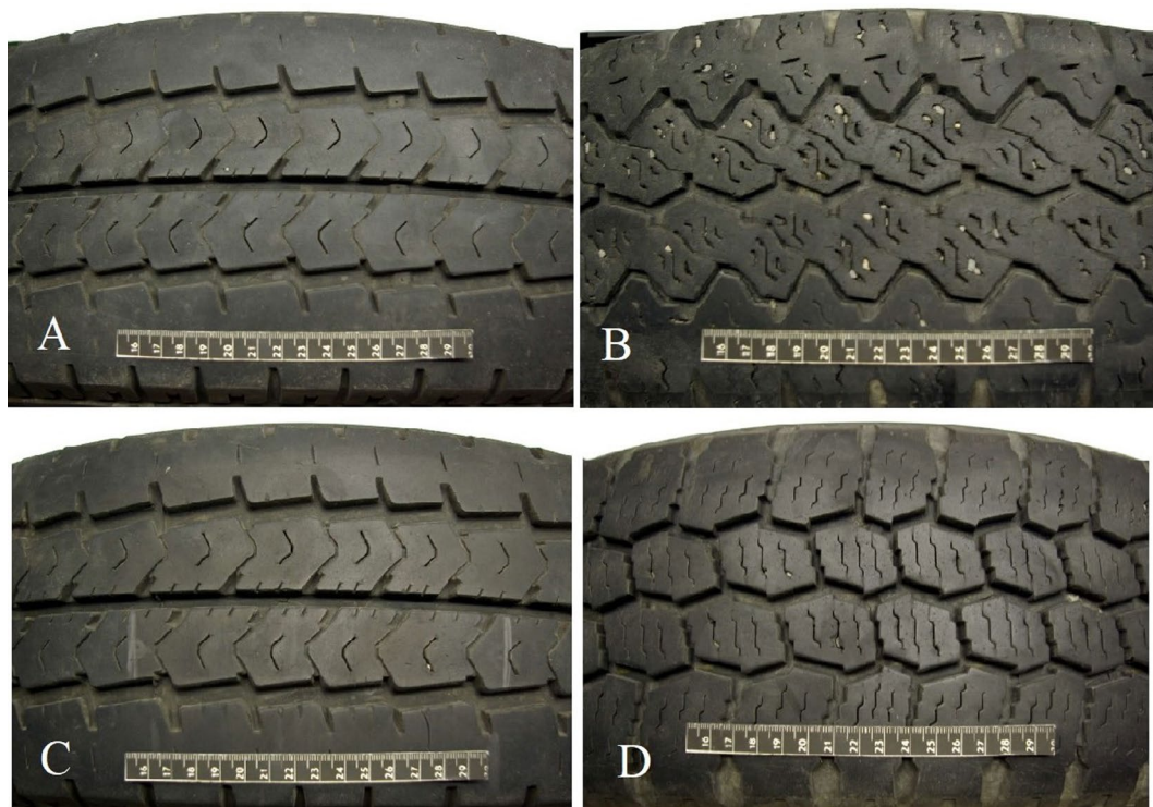
51. ábra – A: bal első (BE) lefoglalt gumiabroncs, B: bal hátsó (BH) lefoglalt gumiabroncs, C: jobb első (JE) lefoglalt gumiabroncs, D: jobb hátsó (JH) lefoglalt gumiabroncs. A gumiabroncsokon háromféle futófelület mintázat figyelhető meg, A = C \neq B \neq D . (a szerző saját felvételei)
