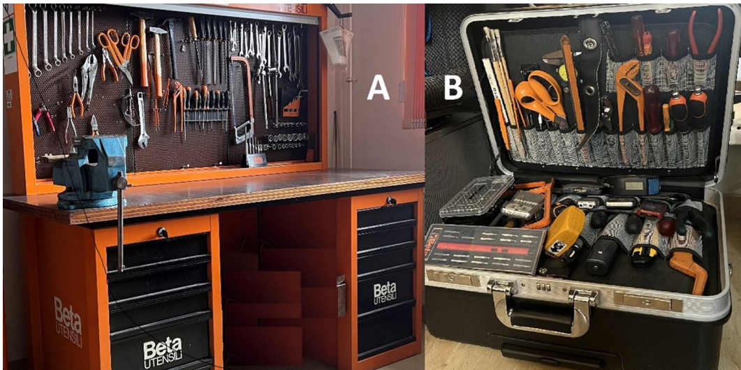
42. ábra – A: előkészítő műhely felszerelése, speciális szakértői célú szerszámokkal, B: eszköznyom rögzítési feladatokra kialakított mobil műhely. (a szerző saját felvételei)
