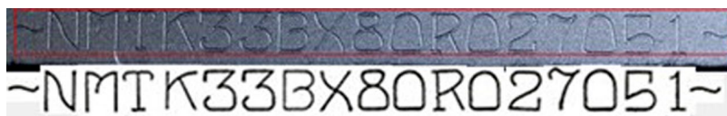
54. ábra – Részletkép a hamis alvázszámról (felül) és a gyári eredetű karakterekről (alul). (a szerző saját felvételei)
